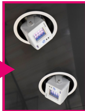
高さ約3.5mの天井から2箇所(ドアノブとタッチパネル)をUV照射
